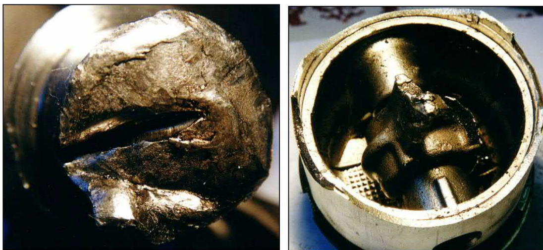
Obr. 1.8 Degradované součásti z převodového a hnacího ústrojí
