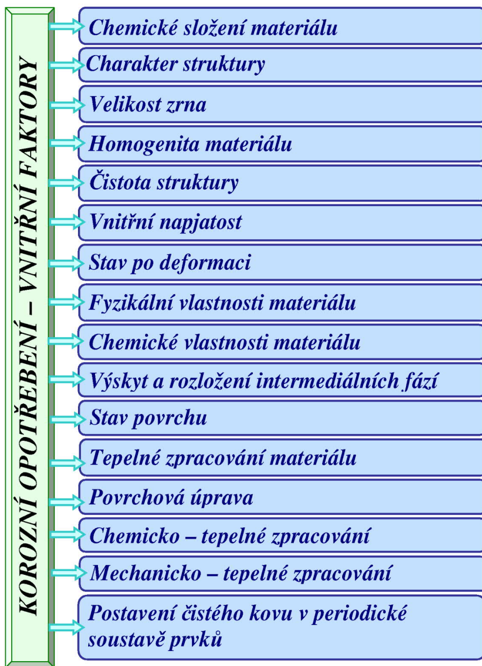
Obr. 6.19 Vnitřní faktory působící na korozní opotřebení
