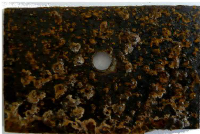
Obr. 8.34 Korozní zplodiny na povrchu testované oceli po expozici v korozní komoře
