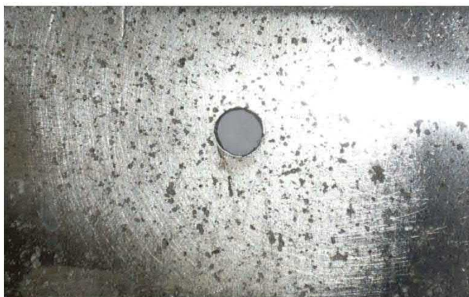
Obr. 8.35 Očištěný povrch po odstranění korozních zplodin
