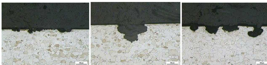
Obr. 8.37 Charakter korozního napadení, sledovaný na leptaných vzorcích (zv 100x)
