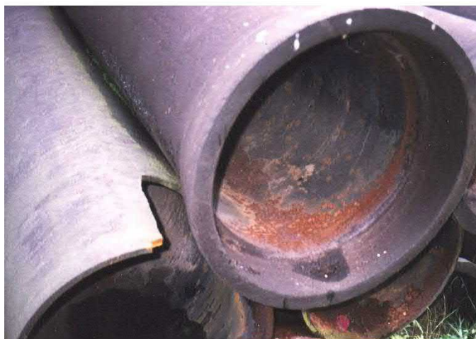
Obr. 6.11 Korozní opotřebení trubek
