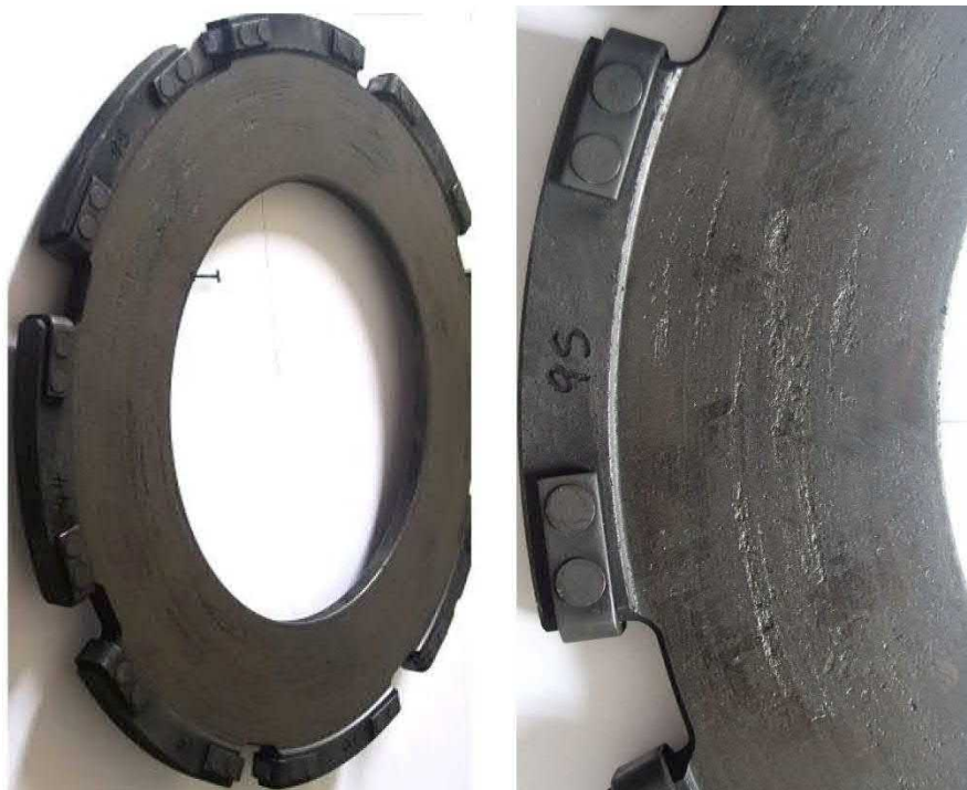
Obr. 5.32 Opotřebení brzdového obložení s detailem vypadaných míst a rýhy
