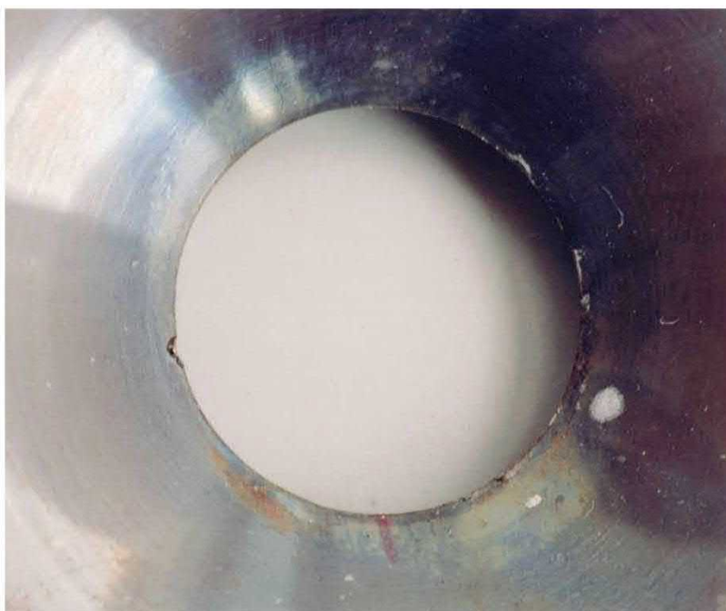
Obr. 8.25 Charakteristické opotřebení materiálu sklářského talíře
