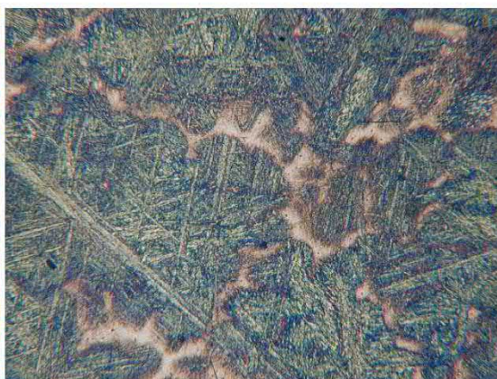
Obr. 8.6 Mikrosegregace legujících prvků v návaznosti na primární stavbu oceli (zv. 50x)
