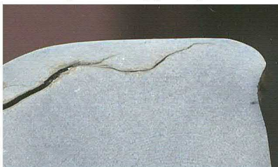
Obr. 8.10 Porušení v souvislosti s lokálním poklesem mikročistoty kovu
