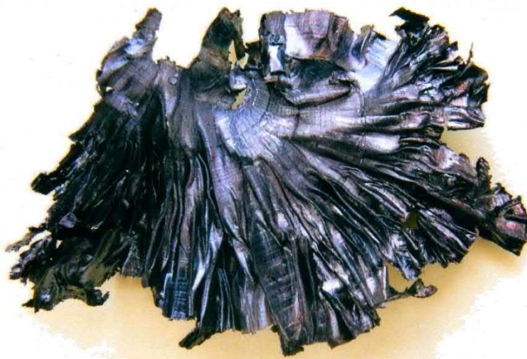
Obr. 5.11 Abrasivní částice z opotřebení železničního kola
