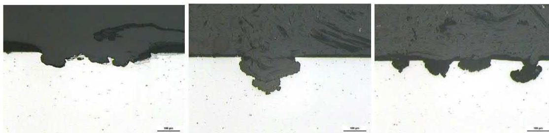
Obr. 8.36 Charakter korozního napadení po expozici v korozní komoře (neleptané, zv 100x)
